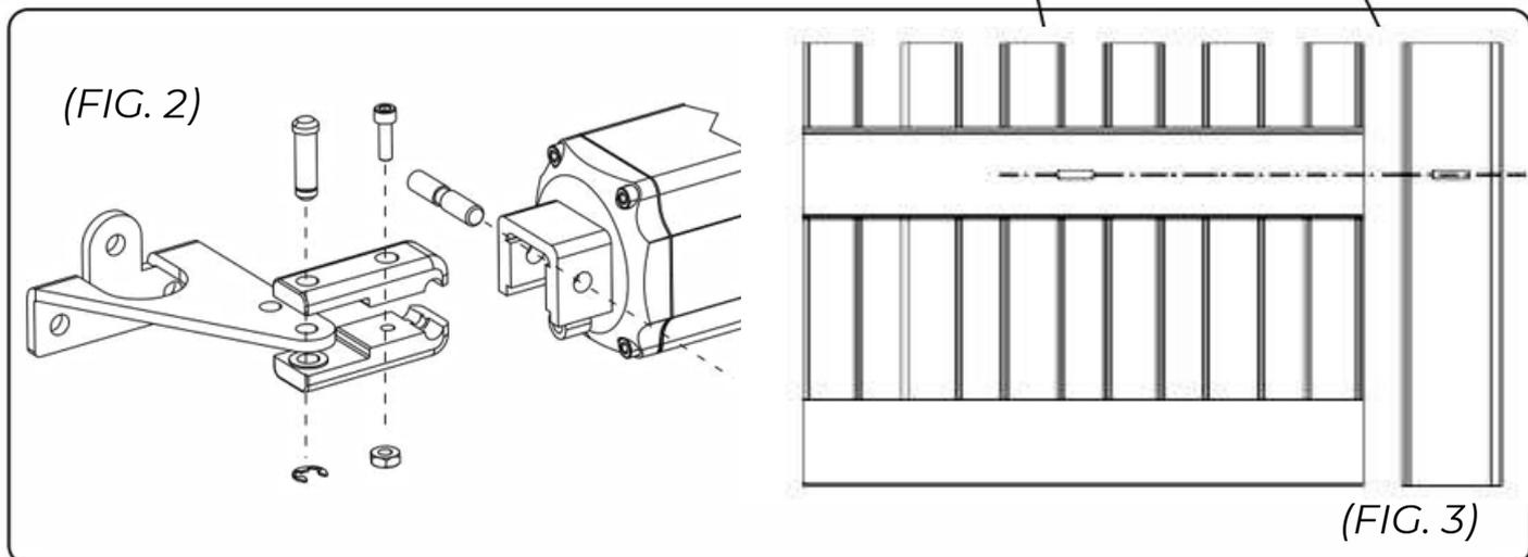
Attention!Lorsque l'on établit la hauteur du sol à laquelle fixer la plaque sur le pilon(FIG.1), tenir compte que la plaque pour l'ancrage du piston sur la grille doit être fixée au même niveau (FIG.3)
